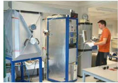
Beschichtungsanlage zur Herstellung von funktionellen Schichtsystemen
