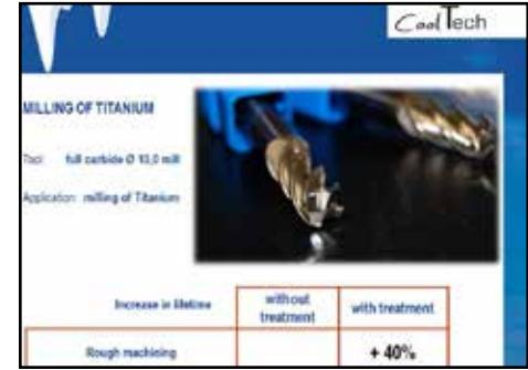
Tieftemperaturbehandelte VHM-Fräser zur Titanbearbeitung
